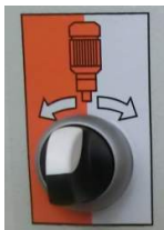
Fig. 12: Modalità operative motore pompa
