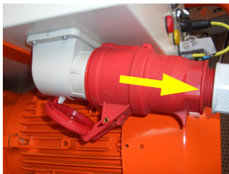
Fig. 66: Staccare il cavo di allacciamento
