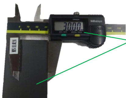
Illustration 52 : Contrôler la largeur des glissières
