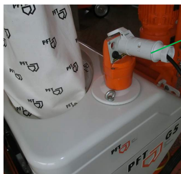
Illustration 36 : Retirer la prise de commande
