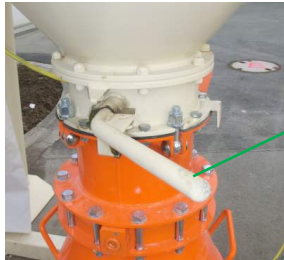
Illustration 32 : fermer le clapet de la sortie du silo
