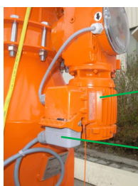
Illustration 20 : Raccorder le câble de commande
