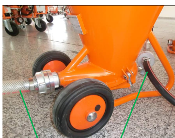
Illustration 15 : Raccorder le tuyau de refoulement
