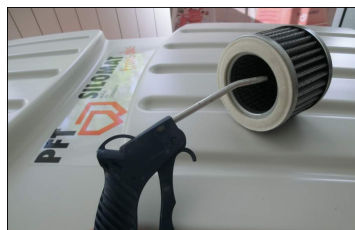
Illustration 50 : Nettoyer les cartouches filtrantes
