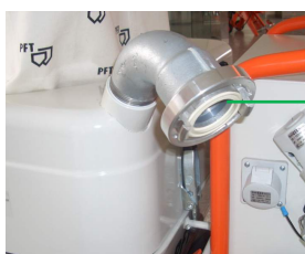
Illustration 15 : Raccorder le tuyau de refoulement
