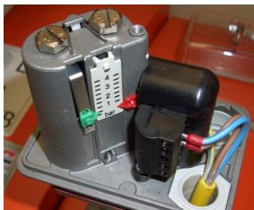
Illustration 53 : Interrupteur de sécurité de la pression de l'air
