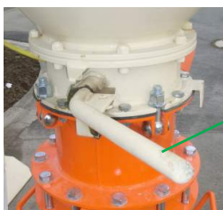
Illustration 21 : Ouvrir le clapet de sortie du silo
