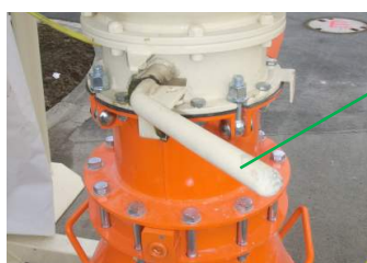
Illustration 39 : Fermer le clapet de la sortie du silo
