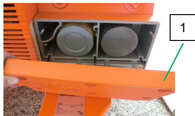
Illustration 48 : Desserrer le couvercle du filtre
