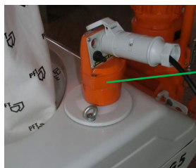
Illustration 19 : Raccorder le câble de commande
