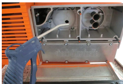
Illustration 51 : Nettoyer le boîtier du filtre
