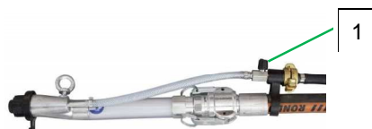
Illustration 58 : Fermeture du robinet d'air
