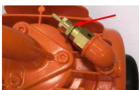
Illustration 90 : Soupape de sécurité
