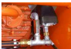
Illustration 89 : Pressostat du compresseur d'air
