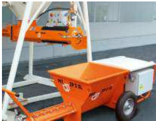
Fig. 27: Llenar la ZP 3 con material
