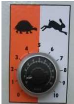
Fig. 13: Regulador del régimen motor de bomba
