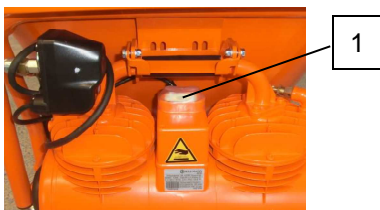
Fig. 43: Compresor de aire
