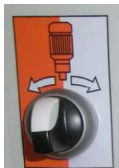
Fig. 50: Cambiar el sentido de giro
