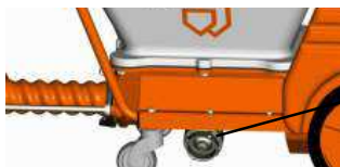
Illustration 35 : Ouverture de l'embout de nettoyage
