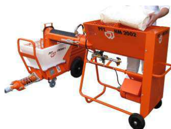
Illustration 37 : Alimenter la machine SWING L en matériau
