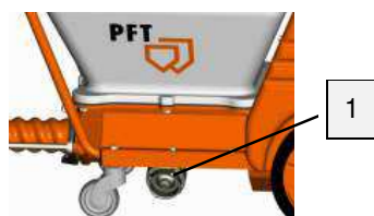
Illustration 77 : Ouverture de l'embout de nettoyage
