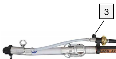
Illustration 51 : Ouverture du robinet d'air
