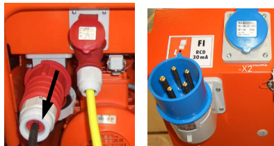
Illustration 81 : Retrait du câble de raccordement
