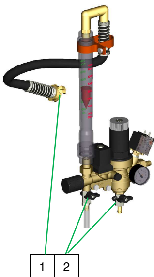
Fig. 65: Separar la toma de agua
