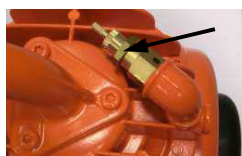
Fig. 78: Válvula de seguridad
