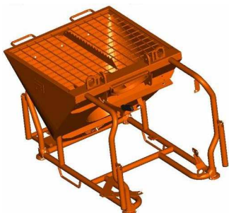
Fig. 6: Módulo del depósito de material
