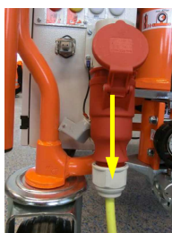
Fig. 70: Retirar el cable de conexión
