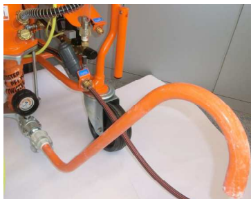
Fig. 23: Tubo de prueba de consistencia
