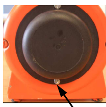
Fig. 73: Apertura de tapa del filtro
