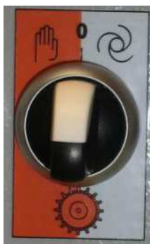
Fig. 12: Modos de funcionamiento de la rueda de celdas
