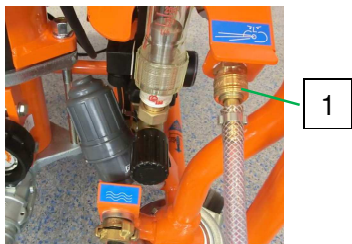
Fig. 30: Conexión de la manguera de aire
