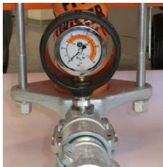
Fig. 4: Manómetro de presión de mortero
