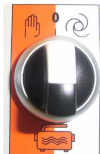
Fig. 13: Modos de funcionamiento de la bomba de agua
