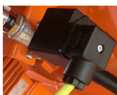
Fig. 77: Interruptor de presión del aire
