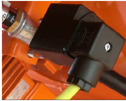
Afb. 104: Drukschakelaar lucht
