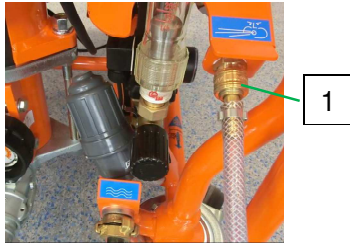
Afb. 57: Lucht slang aansluiten
