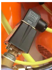
Afb. 103: Drukschakelaar water
