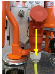
Afb. 97: Aansluitkabel verwijderen
