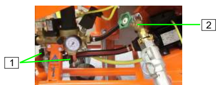
Figure 31 : Fermer les robinets de vidange
