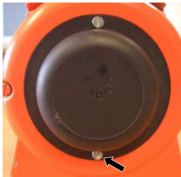
Figure 88 : Ouverture du couvercle du filtre
