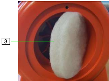
Figure 87 : Filtre du compresseur d'air
