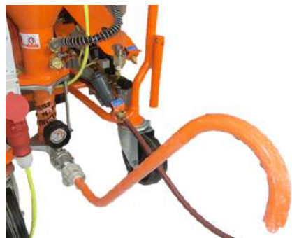
Figure 52 : Tube de contrôle de consistance
