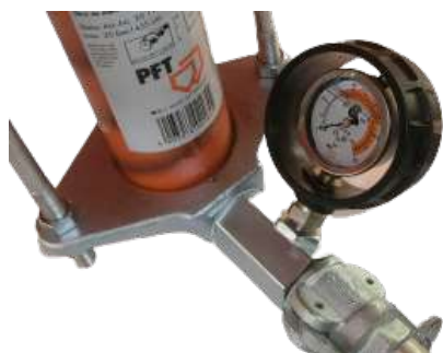
Figure 26 : Manomètre de pression du mortier
