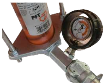
Figure 16 : Manomètre de pression du mortier
