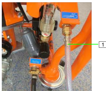
Figure 43 : Raccorder le tuyau d'air
