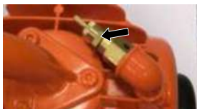
Figure 93 : Soupape de sécurité
