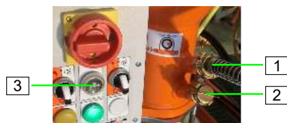
Figure 39 : Alimenter la zone de mélange en eau
