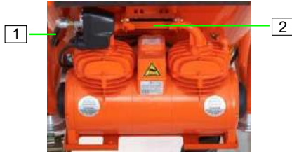
Figure 86 : Retirer le compresseur d'air
