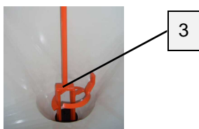
Fig. 106: Remove the agitator
