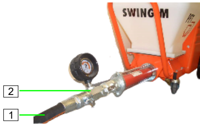
Abb. 21: Mörtelschlauch anschließen
