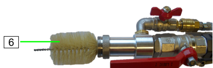
Abb. 47: Spritzgerät reinigen
