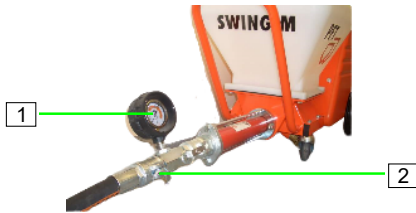
Abb. 43: Mörtelschlauch abkuppeln
