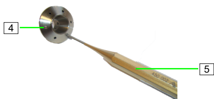
Abb. 46: Düse reinigen
