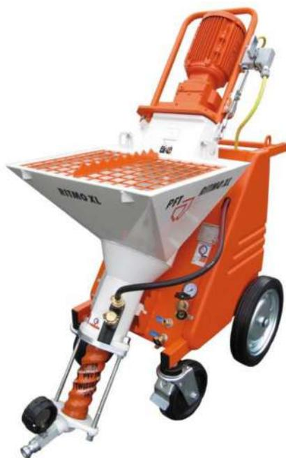
Die kompakte Mischpumpe RITMO XL mit 400V Drehstrom-Antrieb, speziell entwickelt zum Pumpen, Verspritzen und Auftragen von maschinengängigen Trockenmörteln, pastösen Materialien und vielem mehr bis 3 mm Korngröße.
