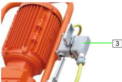
Abb. 27: Motoranschlusskabel anschließen
