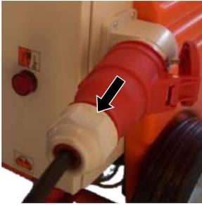
Abb. 82: Anschlusskabel entfernen
