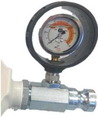
Abb. 22: Mörteldruckmanometer
