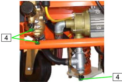
Abb. 60: Ablasshähne öffnen
