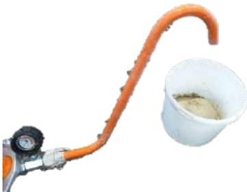
1. Konsistenzprüfrohr am Mörteldruckmanometer anschließen.
