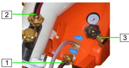
Abb. 59: Wasserzufuhr trennen
