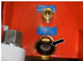
Abb. 85: Schmutzfängersieb im Wassereinlauf
