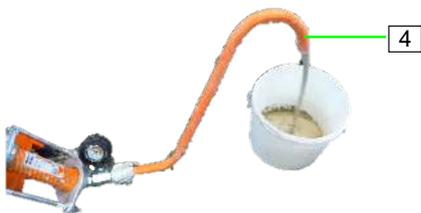
5. Mörtelkonsistenz am Konsistenzprüfrohr (4) prüfen.
