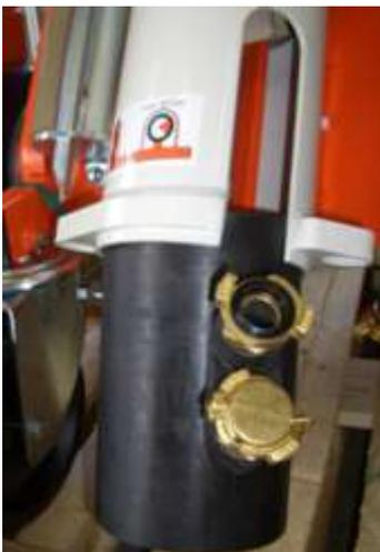
Abb. 75: Gummimischzone reinigen
