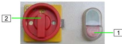
1. Maschine durch Drücken des roten Drucktasters (1) Steuerspannung "AUS" ausschalten.
