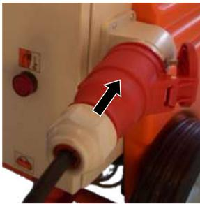
Abb. 25: Stromversorgung anschließen
