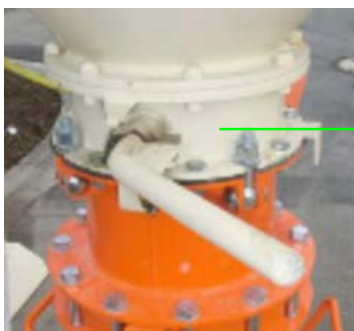
Abb. 39: Siloeslaufklappe schließen
