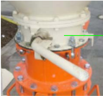
Abb. 22: Siloauslaufklappe öffnen
