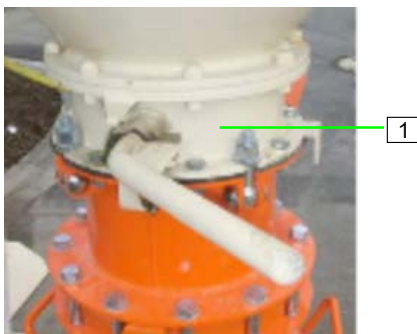
Abb. 32: Siloauslaufklappe schließen
