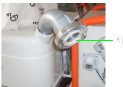
Abb. 19: Förderschlauch anschließen
