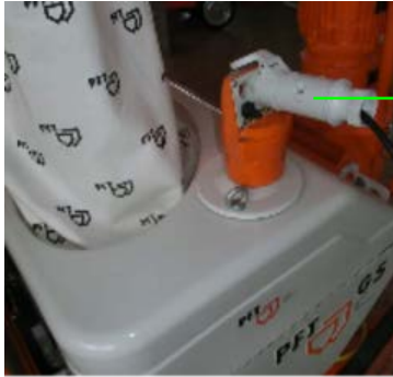
Abb. 30: Steuerstecker abziehen
