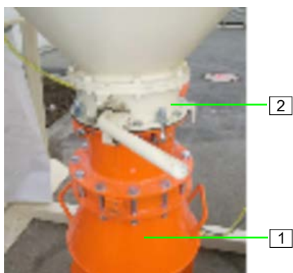
Abb. 18: Fördergefäß anschließen
