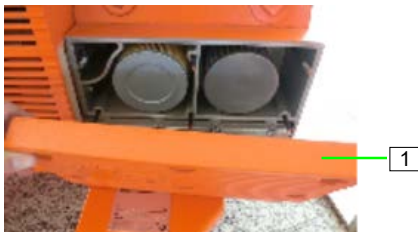
Abb. 59: Filterdeckel lösen
